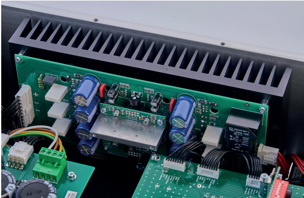
Die Kühlrippen der Endstufen mit den jeweils sechs Bipolar-Transistoren (weiß) liegen zur Wärmeableitung am massiven Gehäuse an
