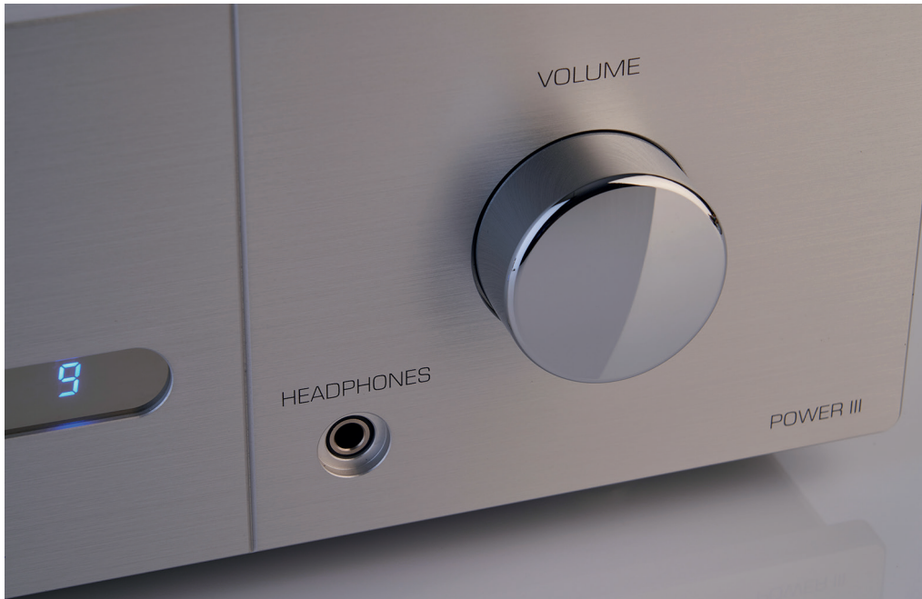
Einer der beiden verchromten Drehregler aus massivem Messing. Der Kopfhörerausgang lässt sich durch einen Stecker aus dem gleichen Material abdecken
